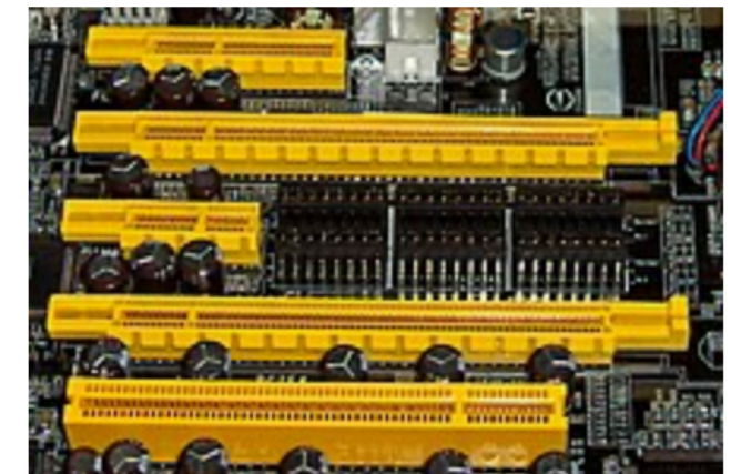
Διάφορες υποδοχές σε μητρική πλακέτα υπολογιστή , από πάνω προς τα κάτω:
